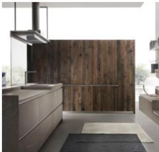
**Le tracce del lavoro dell'uomo.** Vecchi falegnami, esperienza e fatica, tecniche e strumenti usati un tempo, lasciano sulle travi caratteristiche righe parallele. Le porzioni di legno utilizzate sono trattate con un intervento di carteggiatura che riporta alla luce queste testimonianze dal passato, valorizzate e immortalate dall'applicazione di vernice protettiva.
